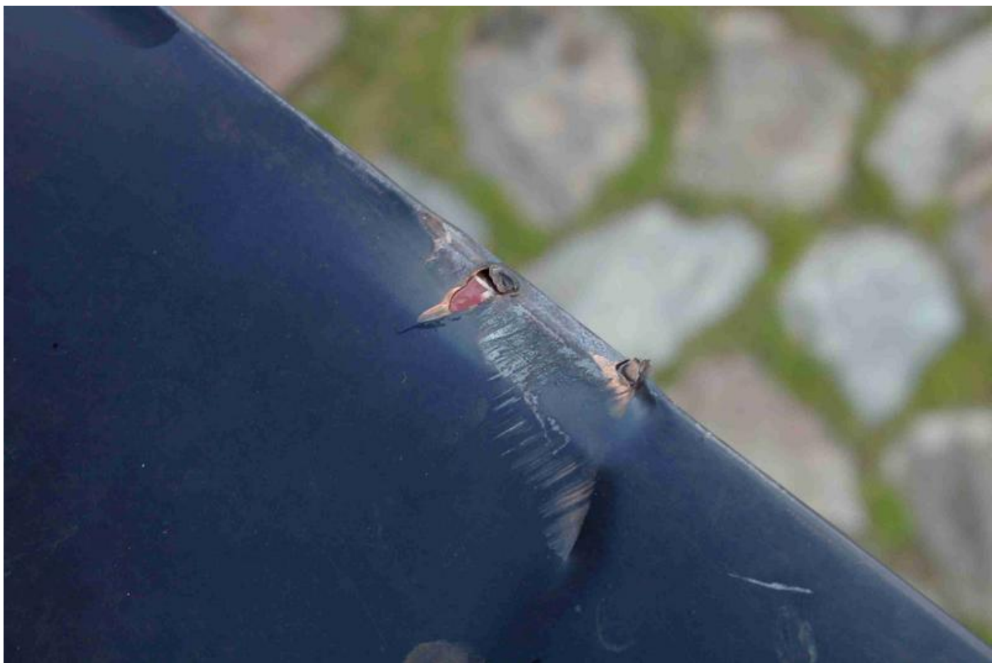
Bild 7 - Ein kleiner Steinschlag, der Schaden ist begrenzt.
